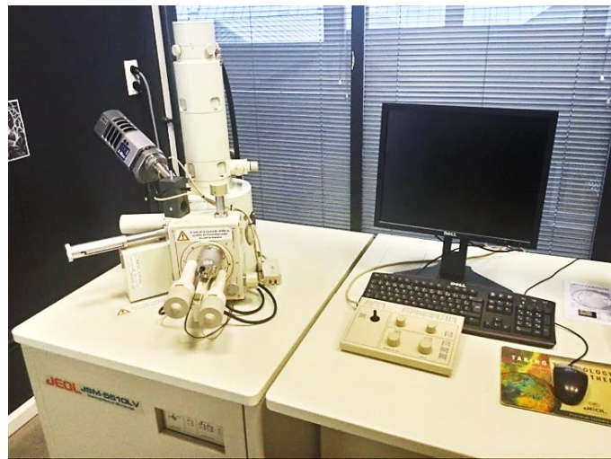
Figure 2.21 : Description du microscope électronique à balayage JEOL JSM-5510V
