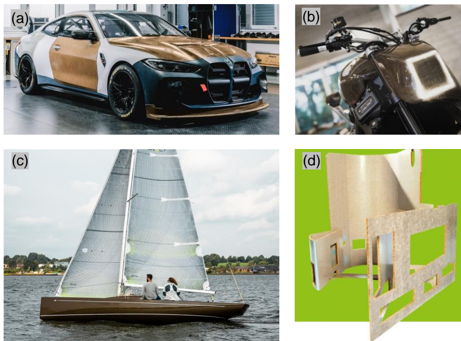
Figure 1.1 : Quelques applications de structure des agrocomposites en fibres longues de lin [1], [2]. a) éléments de carrosserie des véhicules automobile, b) éléments de carrosserie des motos, c) coque de bateau, et d) coque de siège d'avion en classe affaires.
