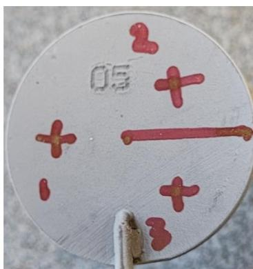
Figure IV-1 – Schéma de répartition des chocs LASAT sur les échantillons pions de l'essai S-FCT, exemple sur l'échantillon PC05.
