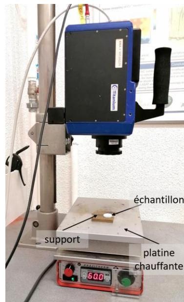
Figure II-22 – Dispositif d'observation par thermographie infrarouge avec sollicitation continue par plaque chauffante
