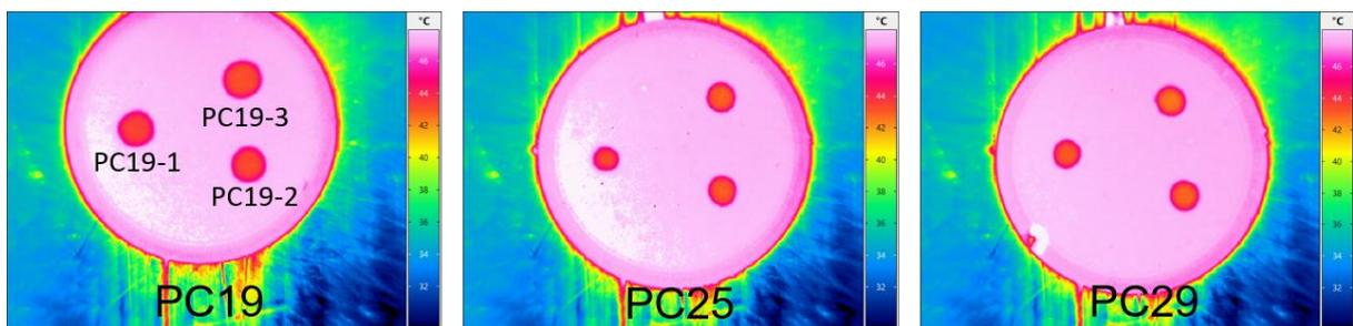
Figure IV-38 – Défauts LASAT introduits respectivement sur les échantillons PC19, PC25 et PC29
