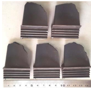
Figure I-2. Aubes de turbine en IN738LC endommagées (Kolagar et al. , 2017)
