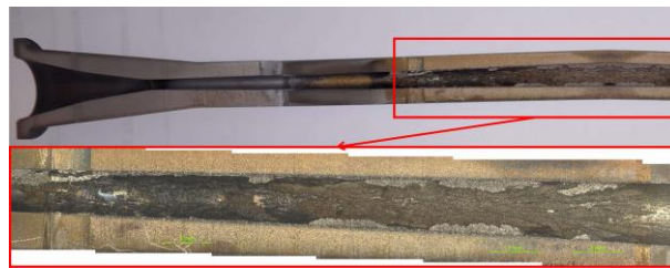
Figure III-20. Vue d'ensemble et de détail d'une buse 24TC bouchée après découpe longitudinale
