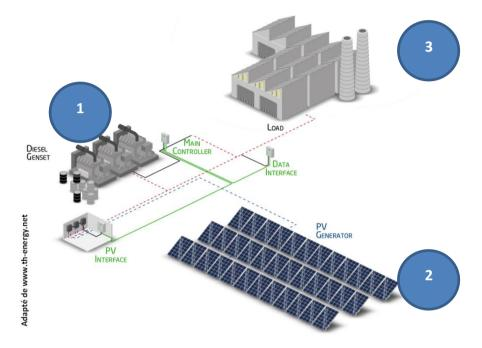
Figure 2 : schéma illustratif du système d'énergie hybride isolé, sans stockage. La zone (1) représente les générateurs diesel, la zone (2) représente le champ photovoltaïque et la zone (3) représente la partie industrielle consommatrice de l'énergie provenant du système hybride (1) + (2).
