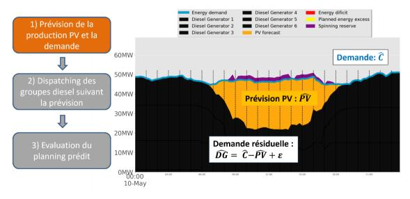
Figure 7 : étape 1 de la méthode de simulation – Prévision de la production PV et de la demande.
