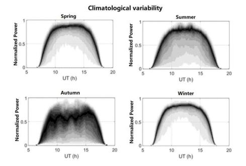
Figure 5 : profils typiques de la dispersion de production photovoltaïque (normalisée par la puissance maximale), pour différentes saisons du cas d'études au Mali (l'axe horizontal est le temps universel d'une journée, l'axe vertical la puissance normalisée de la production PV. Chaque courbe dans ces figures représente une journée de base des données, de plus la couleur est foncée, de plus la probabilité est élevée).
