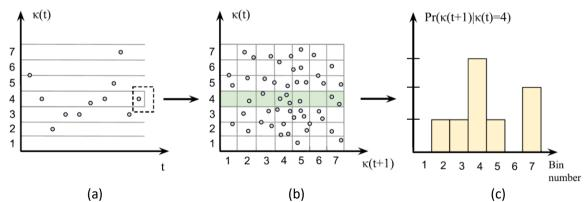
Figure 6 : diagramme d'explication sur la méthode de prévision MCM (Munkhammar et al., 2019). (a)Les éléments de la série temporelle d'indice de ciel clair sont catégorisés suviant plusieurs (ici, 7) classes équiréparties ; (b) : définition de la matrice de transition (ici de taille 7 x 7) entre différentes classes ; (c) : déduction de la distribution de la probabilité de transition pour le temps suivant à partir d'une classe donnée pour le temps présent.)
