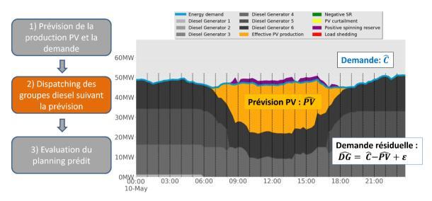
Figure 8 : étape 2 de la méthode de simulation – Optimisation du dispatching des générateurs diesel.
