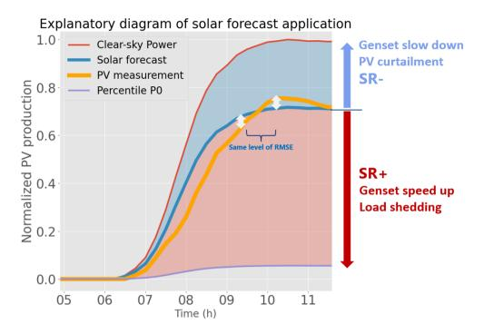
Figure 4 : schéma de la prévision probabiliste et du dimensionnement de la réserve tournante (La courbe rouge est la production en condition ciel clair, la courbe bleue est le niveau médian de la prévision probabiliste, la courbe violette est le niveau le plus bas de la prévision probabiliste, la courbe jaune est la production réelle de PV).
