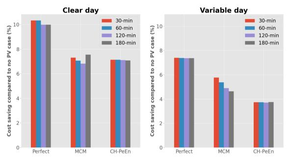
Figure 13 Résultat de la simulation sur l'influence des différentes fréquences de mise à jour
