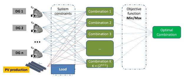
Figure 3 : diagramme d'explication du principe de l'Unit Commitment (DG : Diesel Generator).
