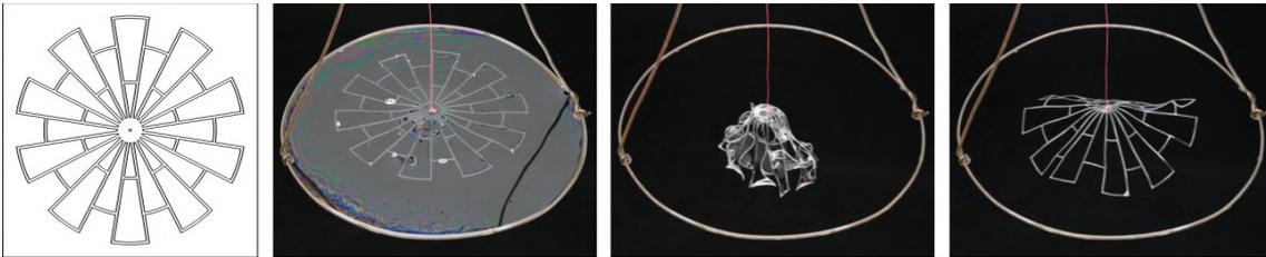
Figure 5 De gauche à droite, le dessin du réseau de Mylar, le réseau à l'équilibre piégé dans un film de savon, le réseau activé par le savon présent dans toutes les cellules et enfin le réseau soumis à son propre poids quand tous les films de savon ont éclaté. Les rectangles sont alignés radialement, ainsi un cône apparaît quand la structure est activée par les films de savon.
