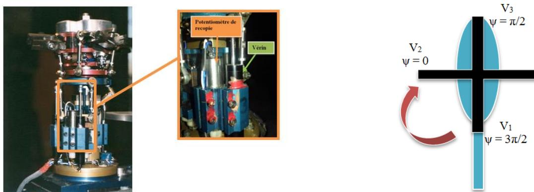
Figure 3.3 - Vue d'un vérin équipant la tête rotor (gauche) et schéma d'implantation des vérins (droite)
