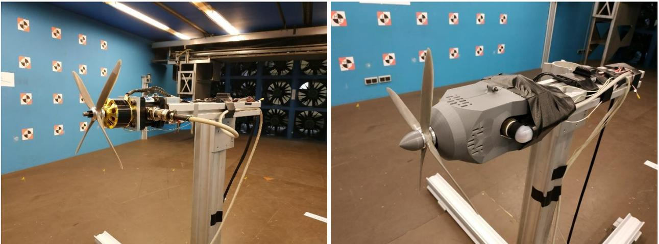
Figure 7.10 - Montage de l'hélice sans (gauche) et avec (droite) le cône et le carénage
