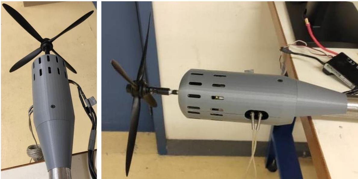
Figure 4.29 - Carénage du moteur et de la balance 2 axes vu du dessus (gauche) et de côté (droite)
