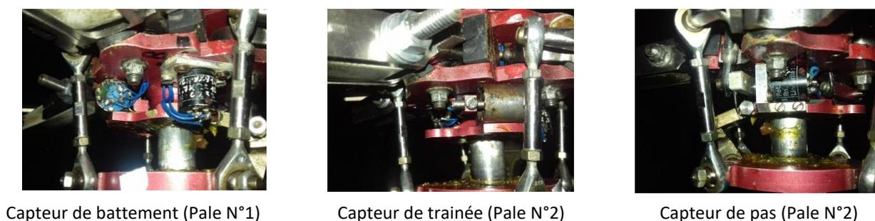
Figure 3.4 - Photographies des capteurs intégrés à la tête rotor
