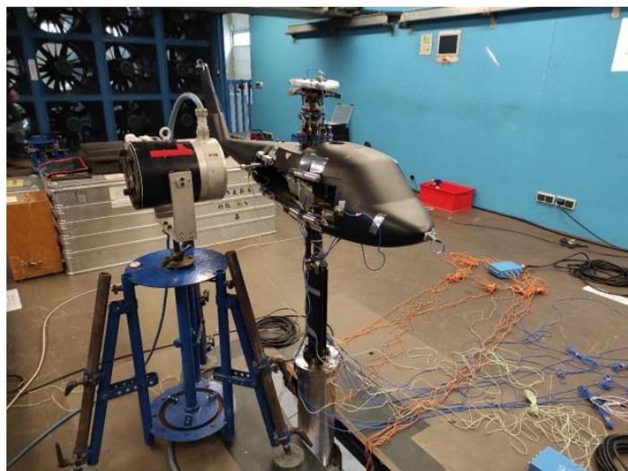
Figure 4.1 - Installation pour la caractérisation vibratoire de l'hélicoptère en soufflerie L2
