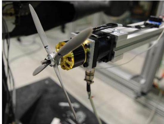
Figure 3.8 - Propulseur APC 11x09-4 (sans cône ni carénage)
