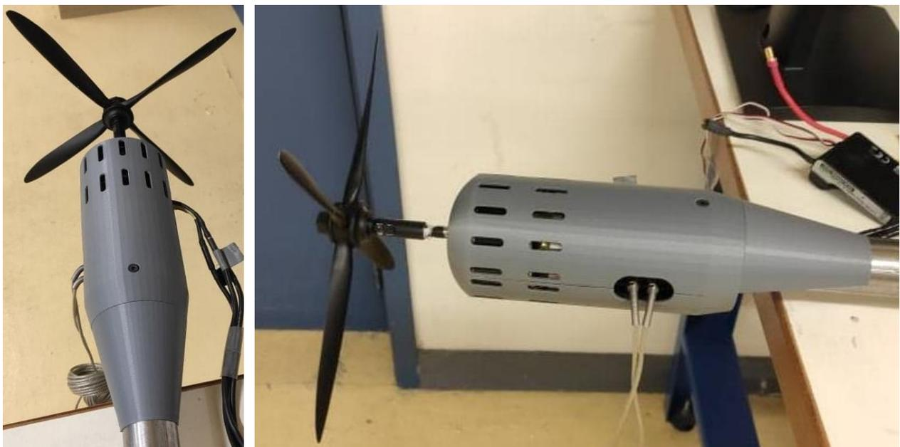
Figure 3.10 - Carénage du moteur et de la balance 2 axes vu du dessus (gauche) et de côté (droite)
