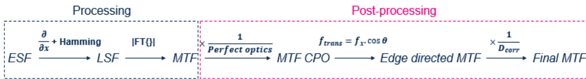
Figure 85 Schéma représentatif du « processing » (de l'ESF à la MTF) et du « post-processing » (de la MTF à la « Final MTF ») utilisés afin de reproduire la MTF de nos capteurs par la méthode du bord incliné.
