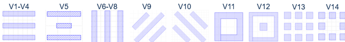
Figure 71 Définition des différentes structures réalisées en gravure sèche sur le pixel de pitch 2.61 \mu\text{m} (CDTI).
