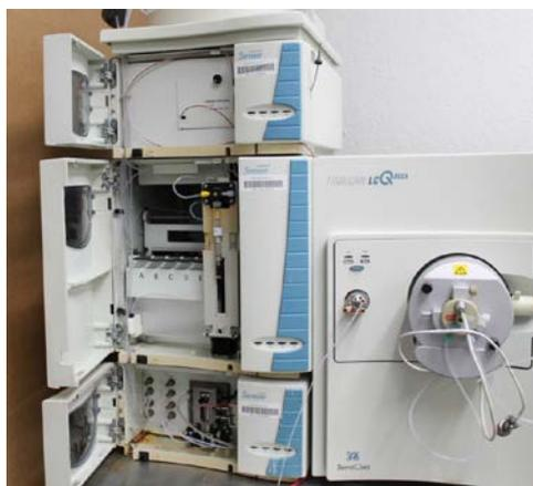
**Figure 2-8 :** Système LC-MS utilisé pour les analyses en mode FIA.
