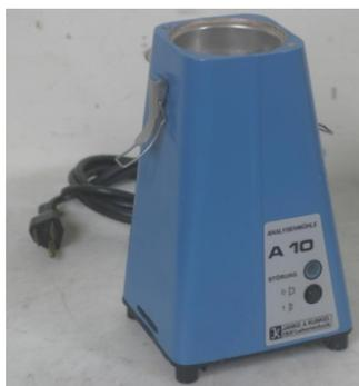
**Figure 2-2 :** Broyeur IKA Labortechnik A10 S2 utilisés pour le cryobroyage des p-FCMs.
