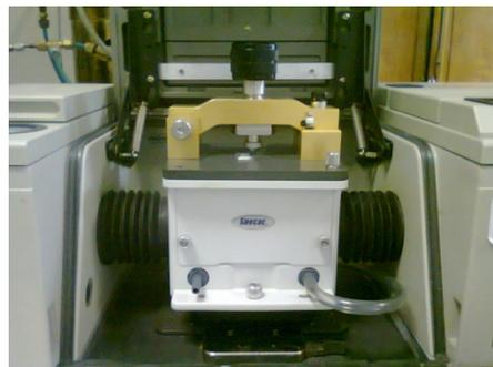
**Figure 2-11** : Appareillage ATR-MIR (Bruker Vector 33) utilisé pour les analyses directes des p-FCMs.
