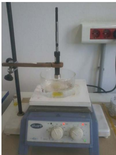
**Figure 2-13 :** Procédure de l'extraction manuelle des composés volatils à partir des huiles d'olive par HS-SPME.
