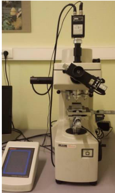
(a) Microduremètre Mitutoyo W640
