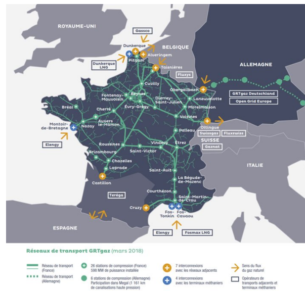
FIGURE 1 – Réseau de transport de gaz opéré par GRTgaz.
