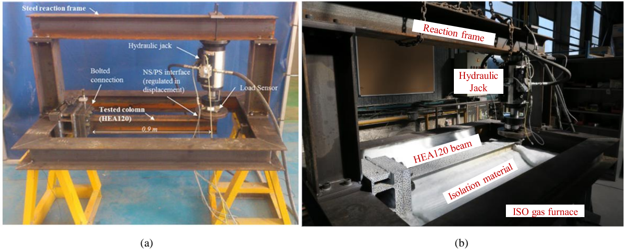
Figure 2.5. Installation des dispositifs expérimentaux lors de la campagne d'essais à froid (a) et la campagne d'essais au feu (b) (Pinoteau et al. 2020)
