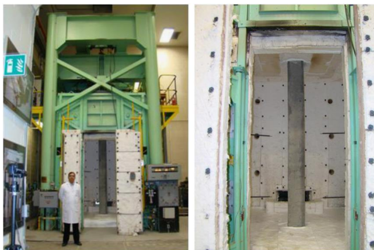
Figure 1.9. Dispositif expérimental avec le poteau testé (Mostafaei, 2013a)
