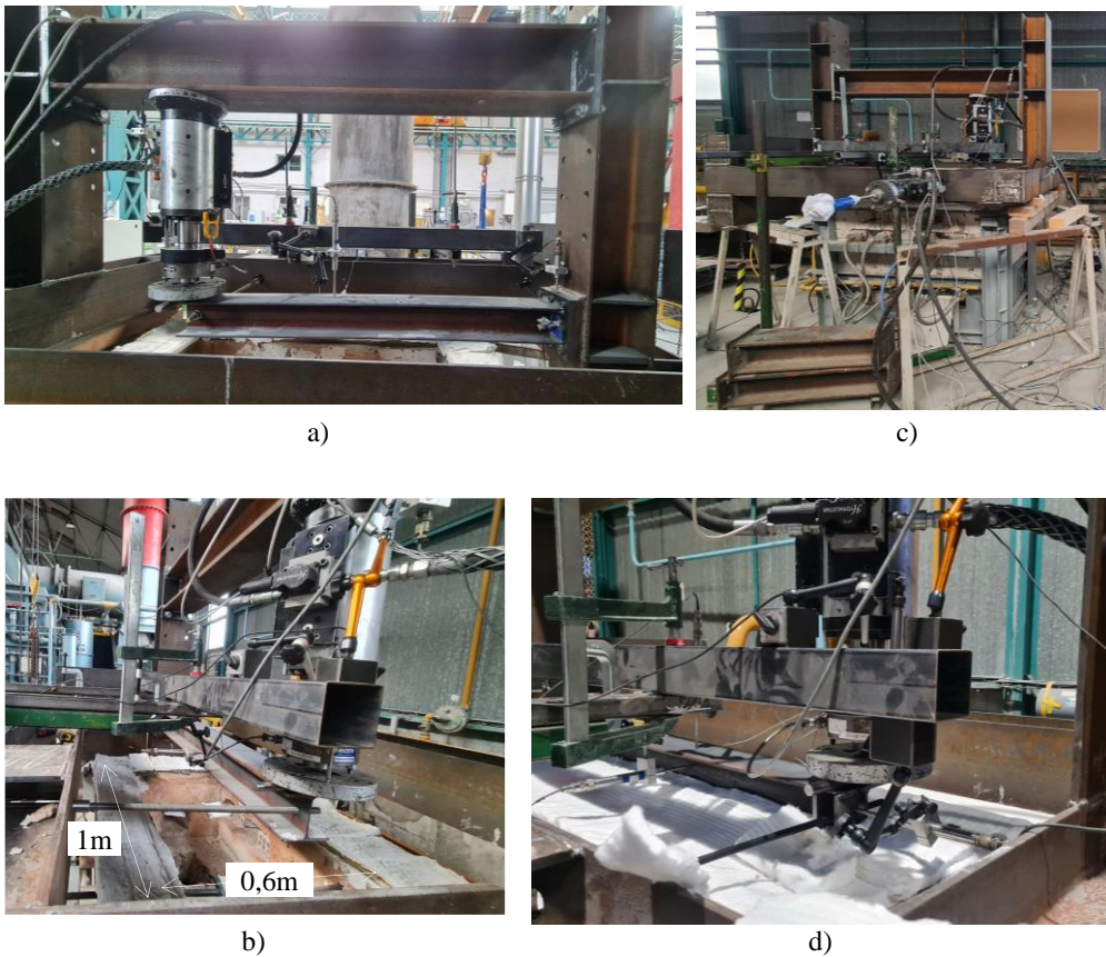
Figure 6.6. a) Photos du dispositif expérimental et b) châssis équipé de deux vérins ; c) châssis supporté par les tréteaux ; d) surface restant du four couverte par des isolations thermiques
