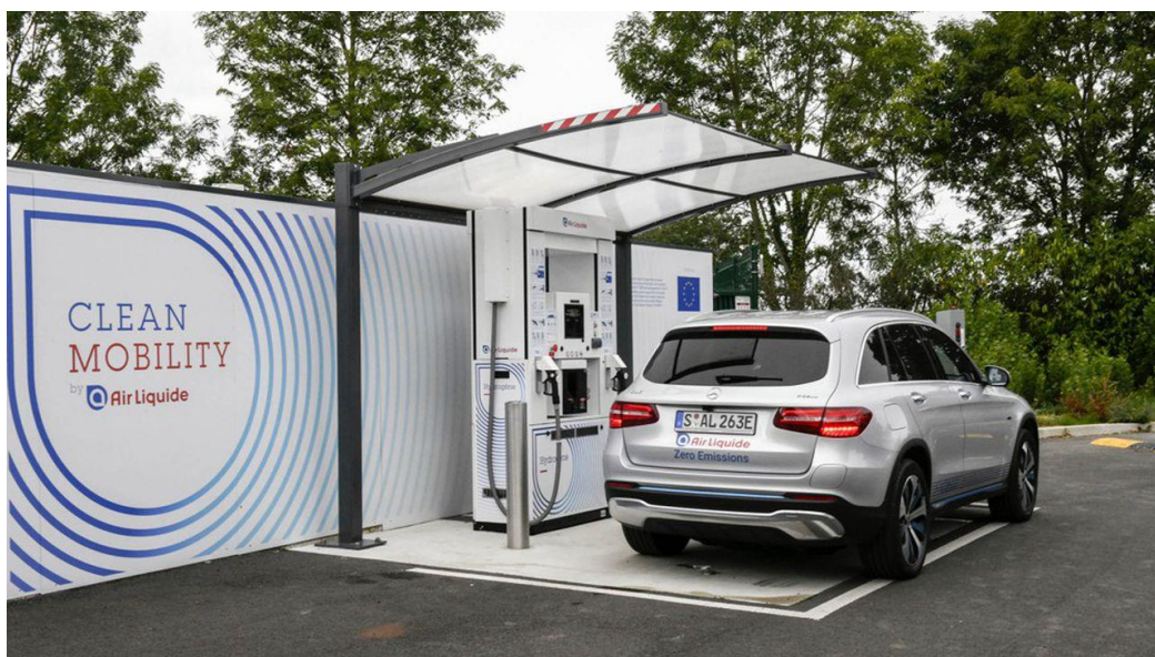
Figure 13 : borne de recharge hydrogène développée par Air Liquide. Source : les Echos
