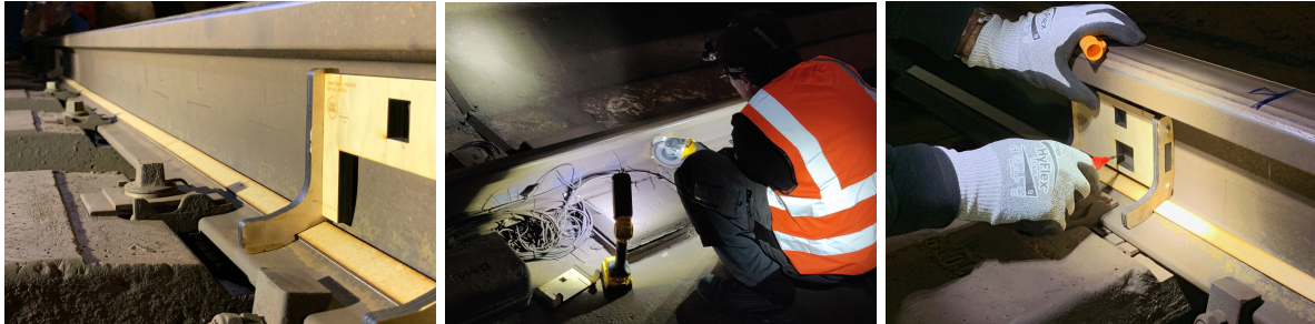
FIGURE 3.8. – Photographies illustrant la procédure de collage des jauges : marquage du rail pour ponçage (gauche), ponçage (centre) et marquage du rail pour collage (droite).
