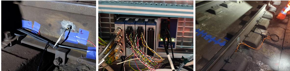
FIGURE 3.7. – Photographies (de gauche à droite) d’un accéléromètre collé au droit de la jauge de déformation 1, du châssis cDAQ avec les modules utilisés (câblés pour l’acquisition) et du carter contenant la boîte de jonction.
