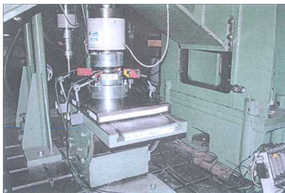
FIGURE 1.12. – Photographies de l'essai de compression des semelles réalisé par la SNCF.
