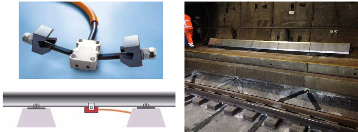
(a) Haut : photographie d'un capteur à fibre optique. Bas : capteur accroché sous le rail, schéma de côté.
