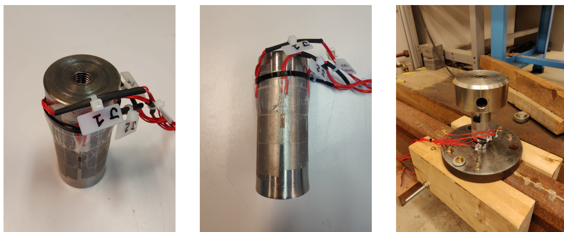
FIGURE 3.17. – Photographies de la cellule de force créée et de son système de support.
