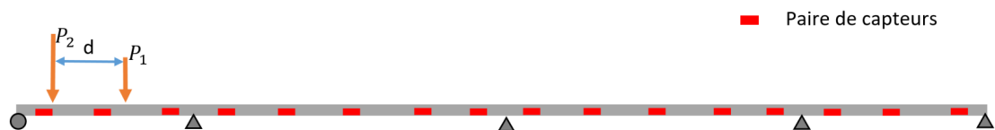
FIGURE 8.10 – Instrumentation des capteurs le long de la structure
