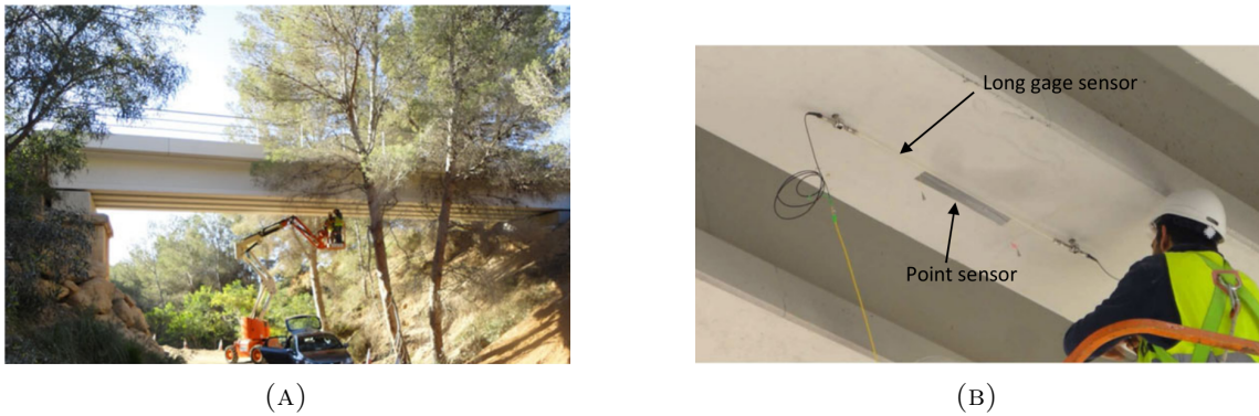
FIGURE 4.13 – Cordes optiques fixées sur le pont Moneder Gulley. Source [39]
