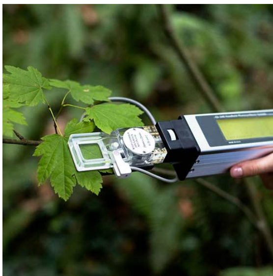
FIGURE 5.3 – Exemple de pince à photosynthèse (image : site de PhytoSciences).
