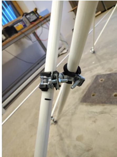
FIGURE 4.37 – Déformation et glissement des connexions.
