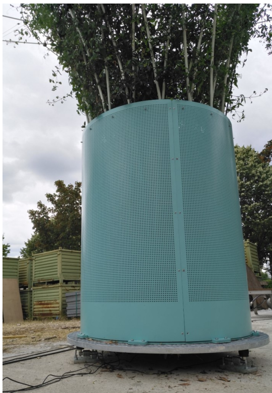
(b) Suivi de la masse du prototype par des capteurs de charge placés sous le caillebotis.
