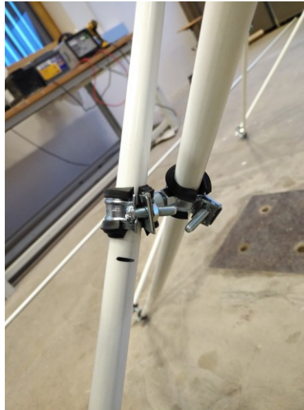
FIGURE 4.37 – Déformation et glissement des connexions.
