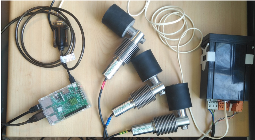
FIGURE 5.1 – Automatisation des mesures. De gauche à droite : Raspberry Pi, capteurs de charge, boîtier d'alimentation Alpha-C.
