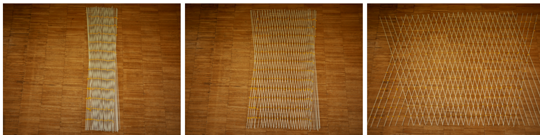
FIGURE 4.27 – Degré de mobilité dans le plan d'une grille bi-directionnelle.
