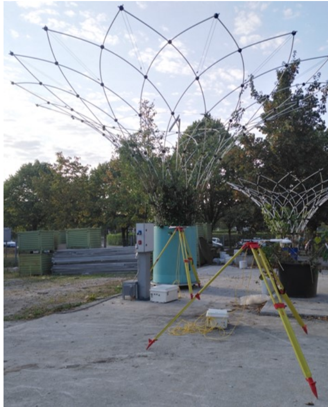
FIGURE 5.5 – Radiomètres CNR4 montés sur trépieds à 1.5 m du sol.
