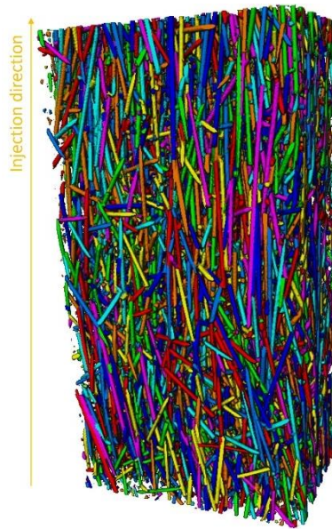
Fig. 2.8 Fibres segmentées et labellisées dans un sous-volume au cœur d'un échantillon de référence non-vieilli et non sollicité.
