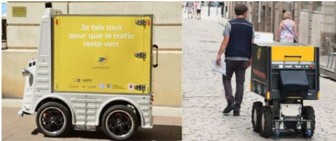
Figure 4 : Chariots suiveurs en expérimentation par La Poste
