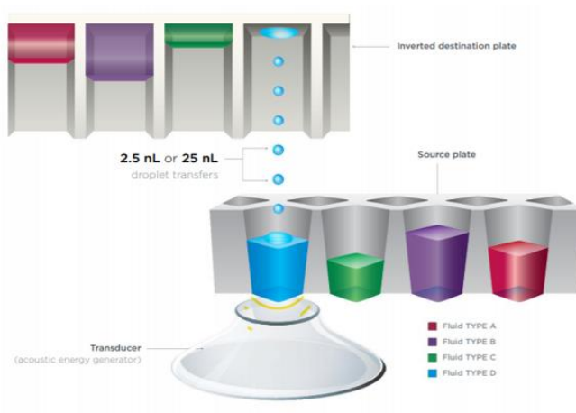
Figure 128 : schéma de fonctionnement de l'Echo ( Acoustic Liquid Handler ). Le transducteur passe sous la plaque source et émet une énergie acoustique répétée qui produit un ménisque
