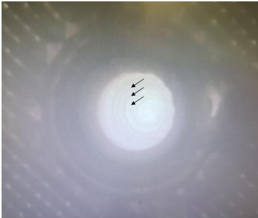
Figure 121 : Photographie de l'observation sous microscope optique d'un puits de la plaque micro-puits en PP imprimée en 3D sur lequel on peut observer une surface non lisse avec des cercles concentriques montrant les effets de l'impression 3D donnant la surface rugueuse.
