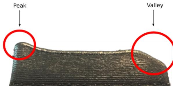
FIGURE 1.12 – Défauts de bord d'une pièce DED [35]
