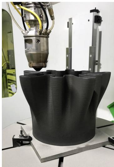
FIGURE 1.4 – Buse d'échappement près des cotes, d'une hauteur de quelques cm, d'une turbine à gaz produite par le procédé DED [14]
