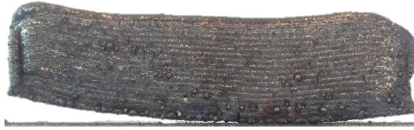
FIGURE 1.14 – Gauchissement d’une pièce DED menant à son détachement du substrat [35]
