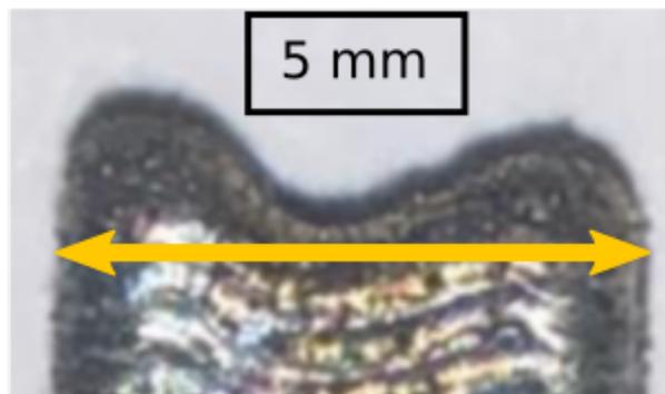
FIGURE 1.11 – Gauchissement de la surface supérieure d'une pièce DED [34]
