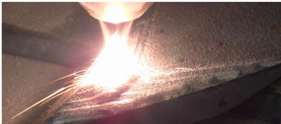
FIGURE 1.7 – Revêtement dur d’un outil d’attaque du sol [23]
