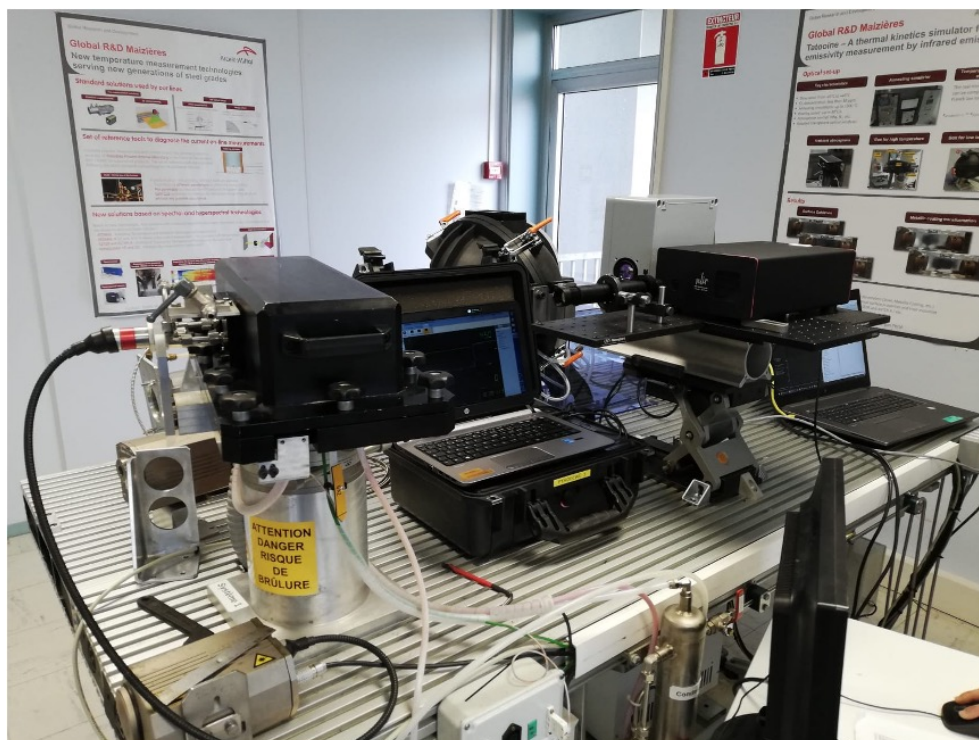
Figure 5.5: Dispositif expérimental de mesure des spectres des échantillons
