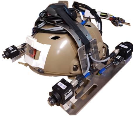
FIGURE 2.1: Casque utilisé pour les acquisitions. Il est équipé de quatre caméras FLIR Blackfly S sur chacun de ses côtés et d'un capteur SBG-Ellipse-N sur le sommet, qui contient une centrale inertielle, un GNSS et un magnétomètre.
