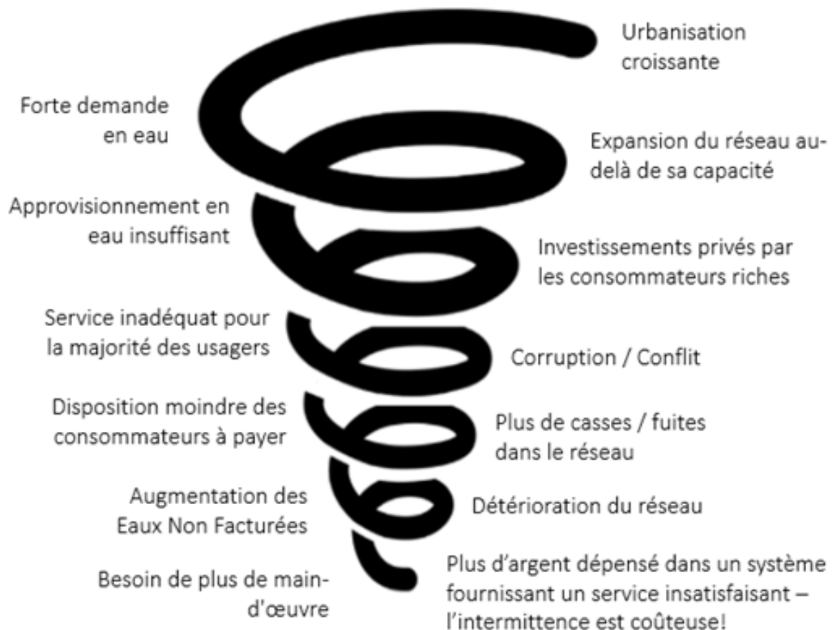
FIGURE 2.8 – Spirale de dégradation du service de la distribution d'eau en intermittence Source : adaptée de (Charalambous and Laspidou, 2017b)
