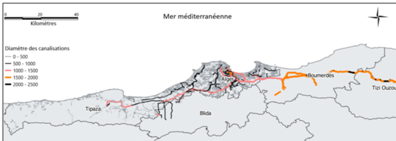
FIGURE 6.8 – Réseau d'eau à Alger et Tipaza en 2019 Source : Elaboration propre, à partir des données de SEAAL
