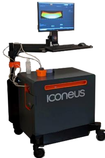
Figure 110. Version finale de l'échographe La structure métallique a été agrandie par rapport à la version préclinique pour pouvoir inclure un transformateur d'isolement et les moyens de protection du patient requis pour une utilisation clinique
