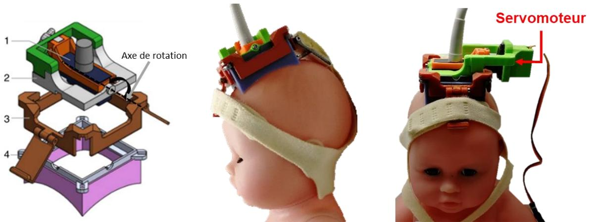
Figure 103. Prototype V0 : ancienne sonde utilisée pour les deux études présentées
