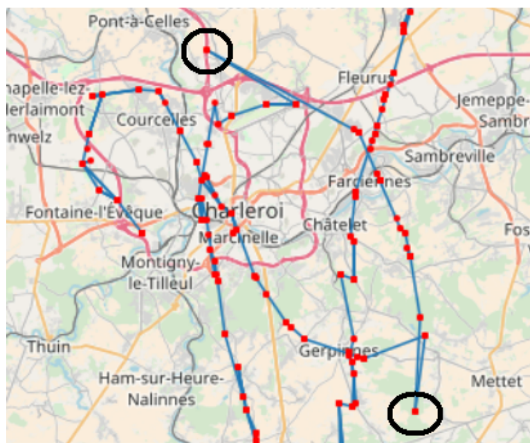
FIGURE 2.1 – Exemple de trajectoire brute, un avion de chasse belge F-16 manœuvre autour de Charleroi. Les positions reçues sont représentées par des carrés rouges, les positions consécutives sont reliées par une ligne bleue. Certains points semblent très écartés de la trajectoire réelle, surtout les deux cerclés de noir, révélant un bruit important dans les données.
