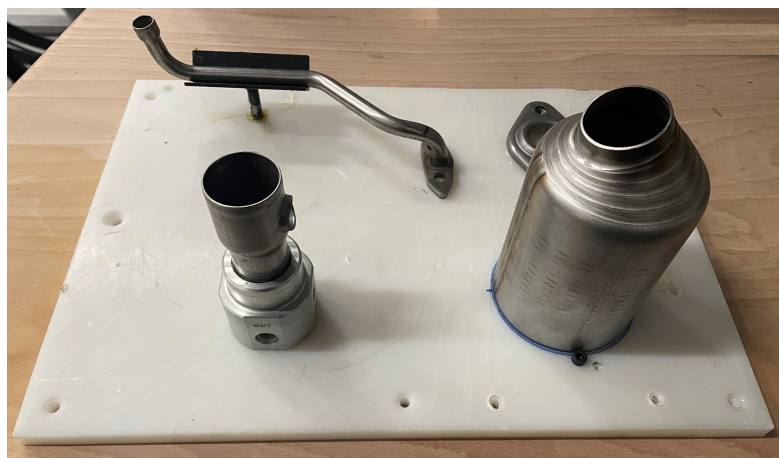
FIGURE 4.5 – Support de mise en position des pièces avant l'assemblage ( kitting )
