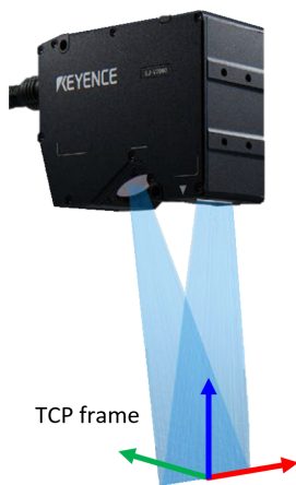
FIGURE 3.1 – Repère TCP du profilomètre laser
