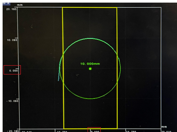
FIGURE 3.2 – Centre de la sphère à l'origine du repère profilomètre
