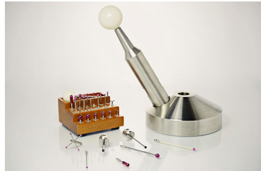
FIGURE 2.15 – Sphère métrologique de calibration
