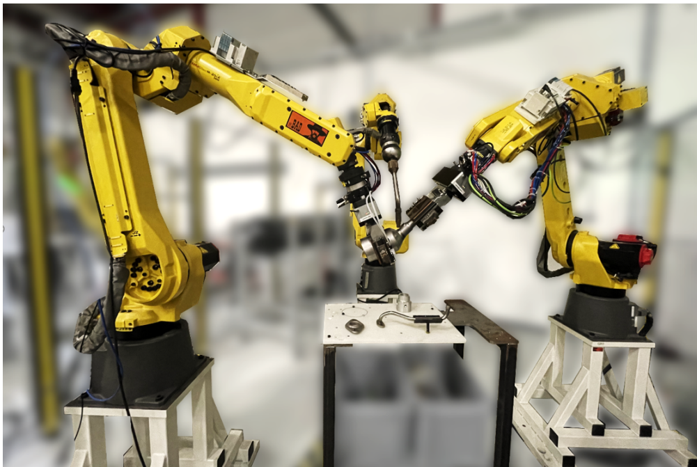
FIGURE 1.7 – Photo de l'installation de la cellule multi-robots
