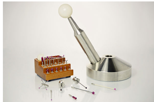
FIGURE 2.15 – Sphère métrologique de calibration
