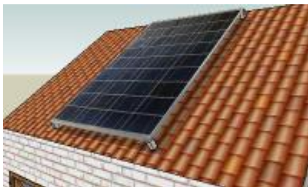
Figure 5.1 : Intégration des panneaux photovoltaïques en toiture
