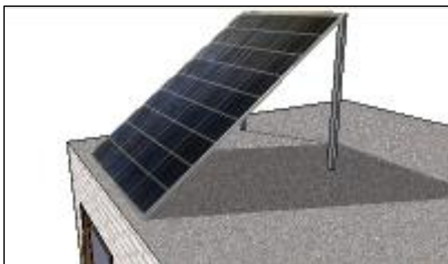
Figure 5.10 : Intégration des panneaux photovoltaïques en toiture-terrasse
