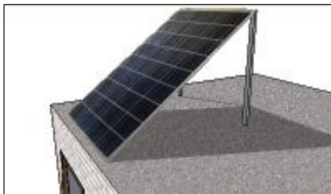
Figure 5.10 : Intégration des panneaux photovoltaïques en toiture-terrasse
