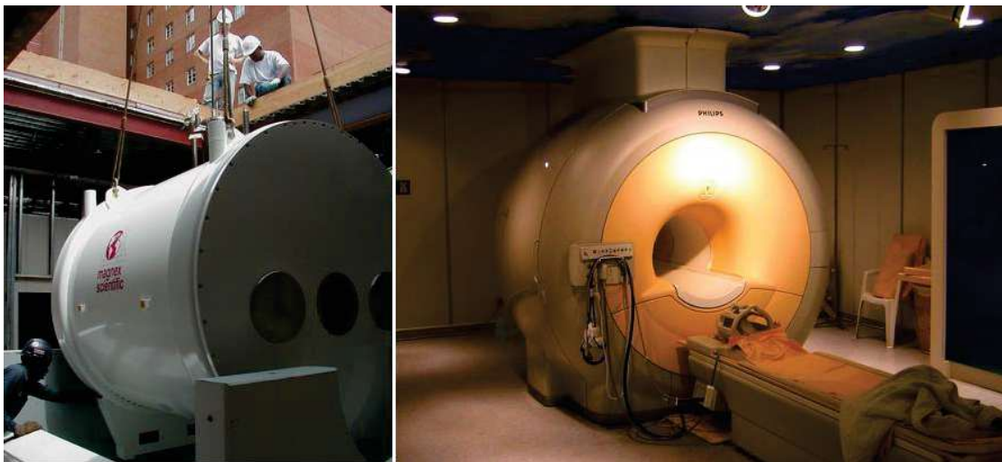
Figure 5 : Deux photos de scanner IRM. A droite une installation d'une unité d'IRM, à gauche une machine IRM 3 teslas que l'on trouve classiquement en clinique. [Wikimédia Commons]
