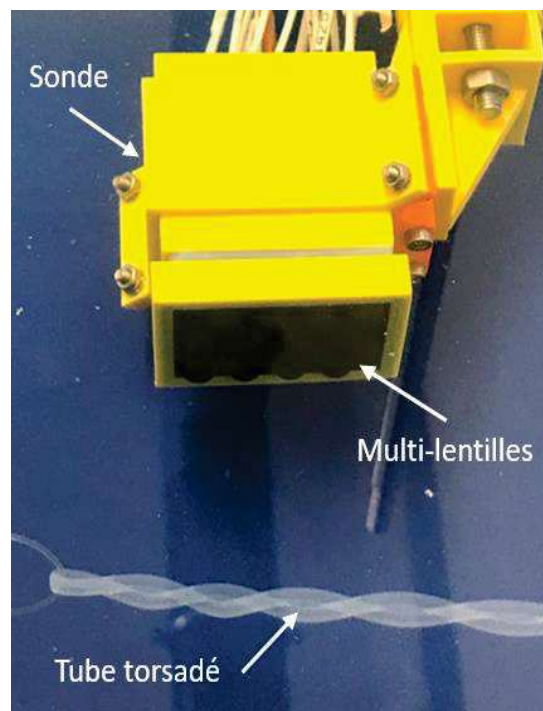
Figure 68: Photo de l'expérience de microscopie de localisation ultrasonore avec la sonde multi-lentilles à larges éléments. La sonde et le tube torsadé sont placés dans une cuve d'eau, une solution de microbulles circule à l'intérieur du tube, à débit constant.
