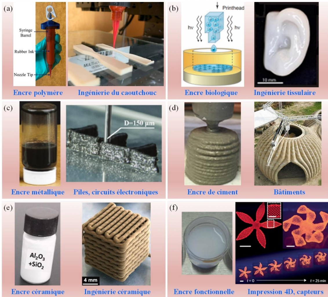
Figure 2.3 Matériaux appropriés et applications correspondantes au DIW : (a) encre polymère dans l'ingénierie du caoutchouc [62] ; (b) encre biologique dans le génie tissulaire [63]; (c) encre métallique dans les batteries [64], circuits électroniques [65]; (d) encre de ciment dans les bâtiments [66] ; (e) encre céramique dans l'ingénierie céramique [67] ; (f) encre fonctionnelle dans l'impression 4D et les capteurs [68]
