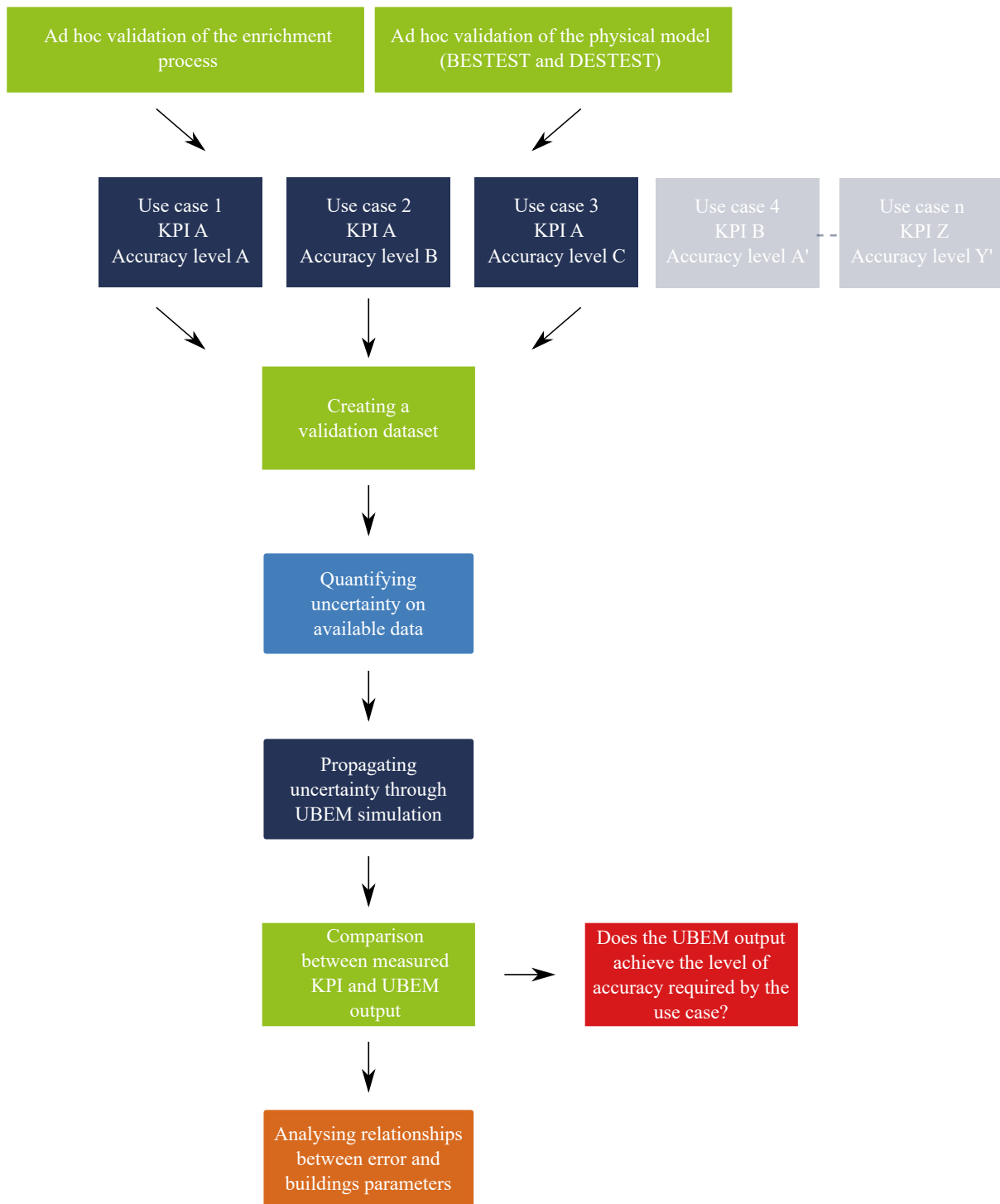
Figure 3: Proposition d'un cadre méthodologique pour la validation des outils de simulation énergétique urbaine
