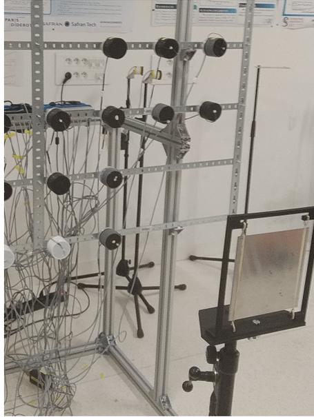
FIGURE 2.9 – Photographie du montage pour l'étude d'une plaque d'aluminium avec des conditions aux limites libres.
