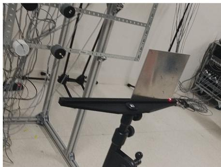
FIGURE 2.4 – Photo du montage pour l'étude d'une plaque d'aluminium encastrée en son bord inférieur.
