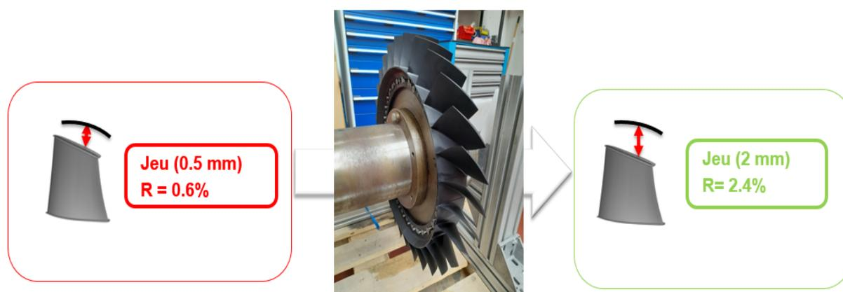
**Figure 4.2** – Aubes de rotor usinées au jeu  $R = 2,4\%$
