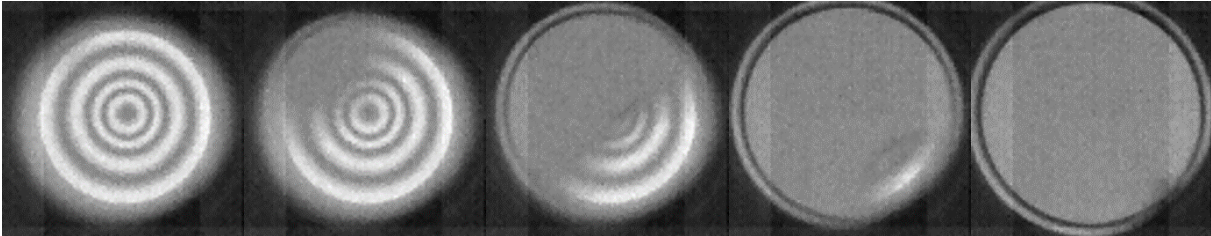
FIGURE 5.8 – Eclatement du film : le trou s'ouvre au niveau du col du dimple. (100 000 fps)
