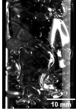
FIGURE 5.19 – Méthode de Bikerman avec un débit plus élevé ( 7.8 \text{ mL s}^{-1} ). Les bulles coalescent dans la colonne de liquide avant d'avoir atteint la surface.
