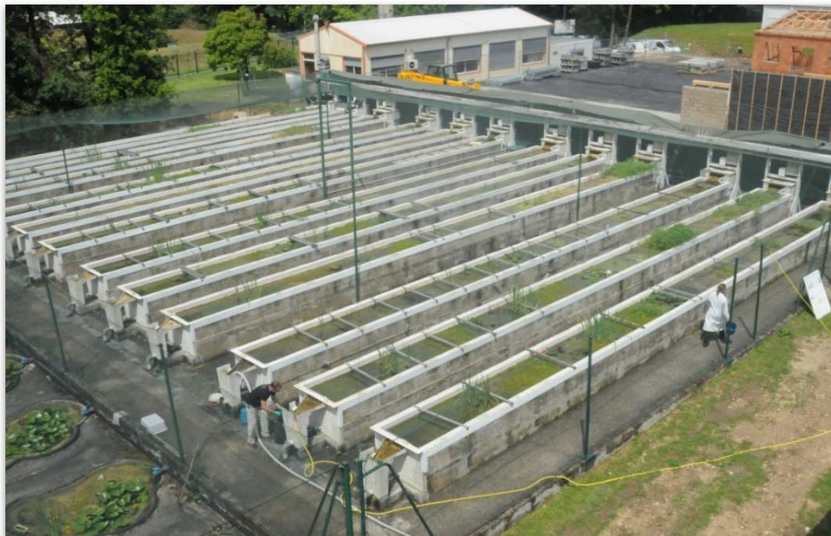
Figure 2. Plateforme expérimentale de l’Ineris composée de douze rivières artificielles.
