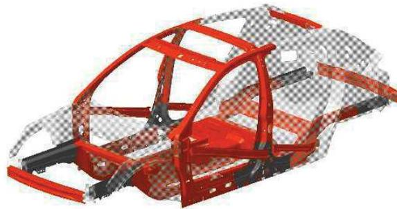
**Figure I. 2 : Pièces de la caisse en blanc anti-intrusion en rouge et pièces destinées à l'absorption d'énergie en gris [Arc02].**
