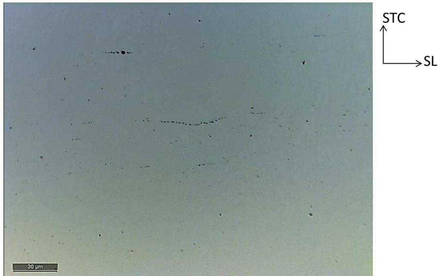
Figure 2. 31 : Micrographie optique d'inclusions dans la nuance B.
