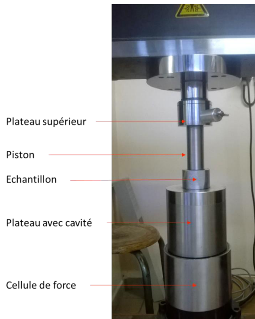
FIGURE 2.30 – Dispositif expérimental de l'essai de push-out (issu de Menet (2017))
