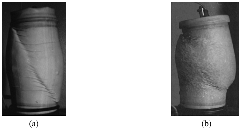
FIGURE 2.10 – Bande de localisation après essai de compression triaxiale : (a) sable fin (b) sable grossier (issu de Desrues et Andò (2015))
