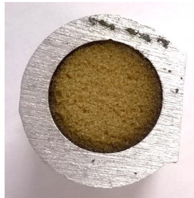
FIGURE 2.28 – Gradient thermique radial dans l'éprouvette
