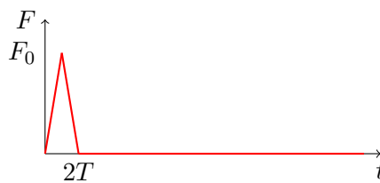
FIGURE 5.27 – Chargement imposé au niveau des marteaux
