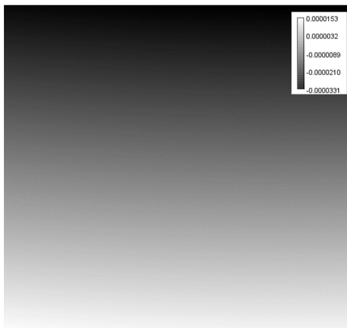
FIGURE 4.10 – Carte de différences de l'interféromètre biréfringent. La valeur de la différence de marche est représentée en niveaux de gris. La différence de marche varie uniquement dans la direction verticale, ce qui correspond à des franges horizontales.
