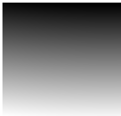
FIGURE 3.12 – Carte de différences de l'interféromètre biréfringent de notre banc expérimental. L'axe vertical correspond à la direction du balayage. L'échelle de niveaux de gris représente la valeur de la différence de marche sur chacun des pixels.
