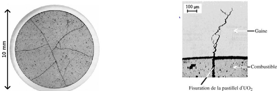
(a) Exemple de fissuration d'une pastille de combustible.
