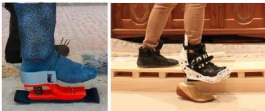
Figure III.8: Prototypage de pied prothétique avec un simulateur de prothèse (Kamel et al., 2020; Yap & Renda, 2015)
