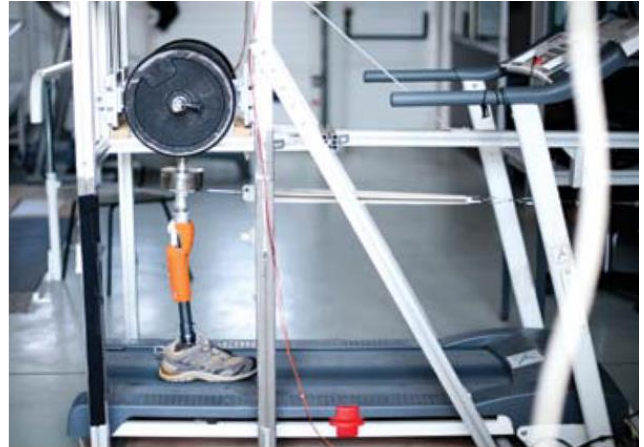
Figure III.19: Principe du banc de test de résistance à la fatigue lors de la marche (à gauche) (Durauffourg, 2021) et banc de test de résistance à la fatigue lors de la marche développé par Proteor™ (à droite) (L'Usine Nouvelle)
