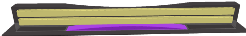
Figure I.18: Placement des FR dans la configuration du Test2F. En jaune les FR et en violet le support d'impression.
