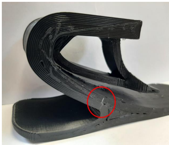
Figure III.23: Localisation de la rupture lors du test de résistance à la fatigue après 23 000 cycles du prototype R en PLA Tough
