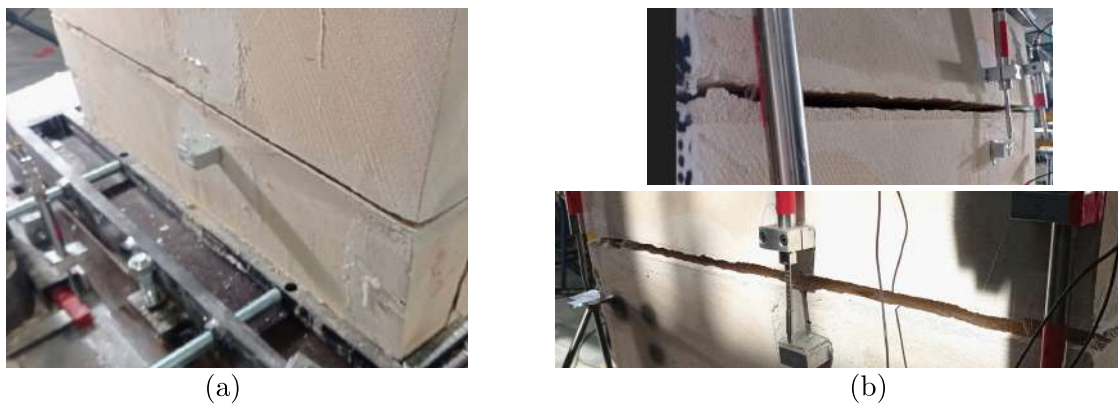
FIGURE 8.28 – (a) Rupture de l'interface pierre mortier ; (b) Rupture du mortier en traction
