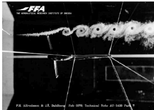
FIGURE 2.13 – Mise en évidence de l'existence de vortex de bouts de pale tiré de [120]
