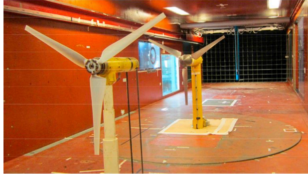
FIGURE 3.1 – Dispositif expérimental de deux éoliennes en tandem tiré de [24]
