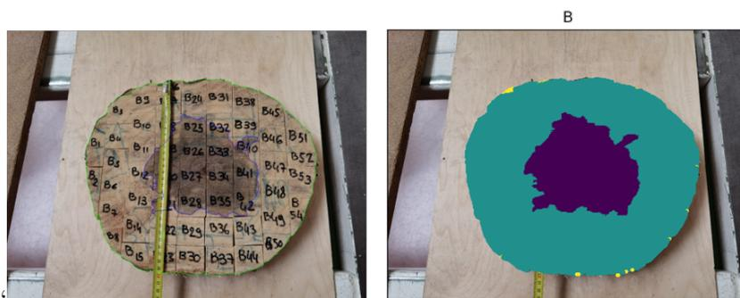
FIGURE 4.1 – Délimitation du faux-cœur sur le logiciel ImageJ (à gauche) et estimation de la proportion d'aubier et de faux-cœur dans le tronc via un code écrit en Python (à droite) - Peuplier B (parcelle AF)
