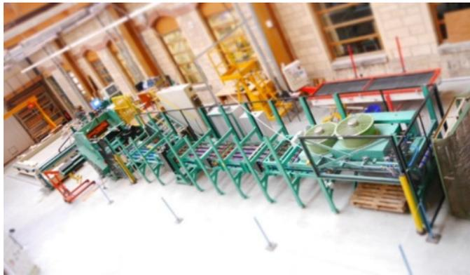
FIGURE 5.1 – Dérouleuse instrumentée du LaBoMaP (ENSAM, Cluny)
