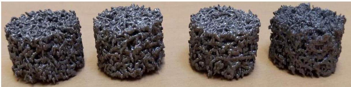
**Figure 81** *Impression 3D en titane d'échantillons issus du générateur par fusion sur lit de poudre.*
