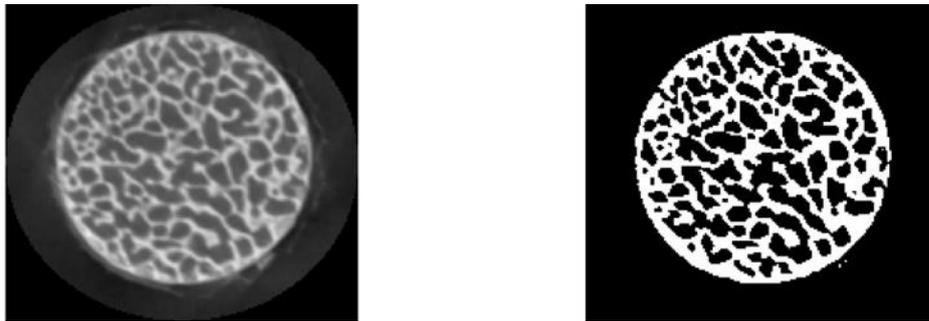
**Figure 34** Binarisation d'une coupe  $\mu$ -CT d'os trabéculaire fémoral bovin de résolution 80  $\mu$ m à l'aide d'une méthode d'Otsu à plusieurs niveaux [3].
